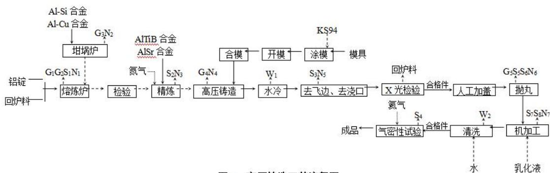
图 1 高压铸造工艺流程图
